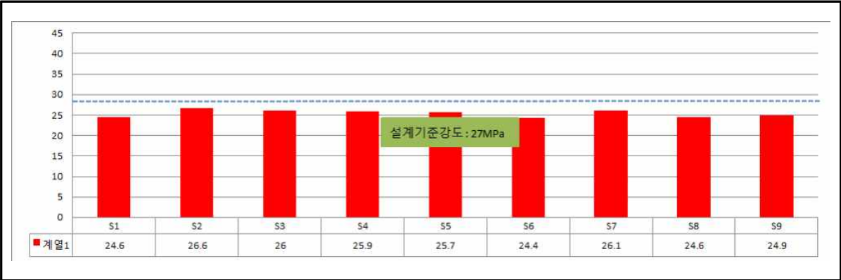
<그림 3.10> 콘크리트 강도조사 결과 (상부구조 안심방향)
