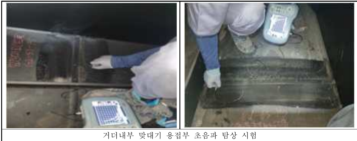
<그림 3.20> 초음파 탐상(사각법) 시험
