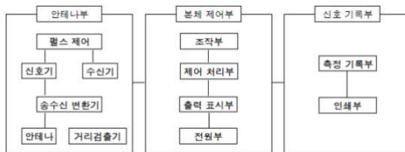
<그림 3.15> 전자파 레이더법에 의한 철근탐사장비의 장치 구성도
